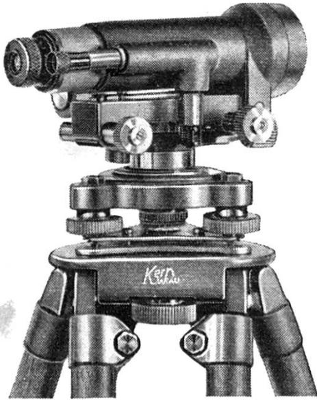
für genaue technische Nivellements und grössere Längennivellements, mit und ohne Kreis lieferbar.
