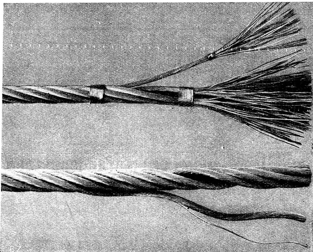
Oben: Drahtseil 15 mm  $\varnothing$ , 222  $\times$  0,7 mm verzinkter Stahldraht, nicht vorgeformt.
