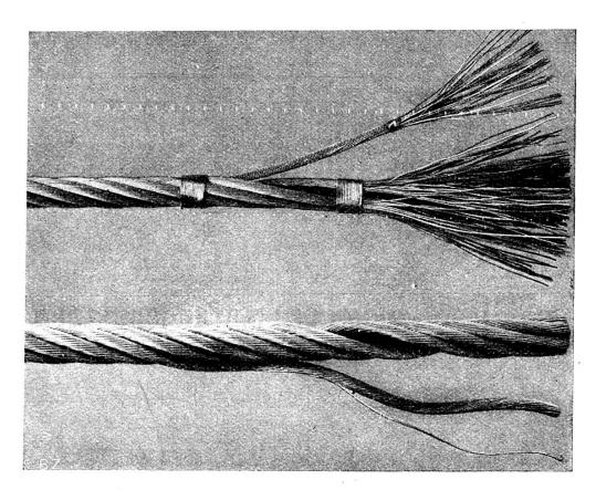
Oben: Drahtseil 15 mm  $\phi$ , 222  $\times$  0,7 mm verzinkter Stahldraht, nicht
