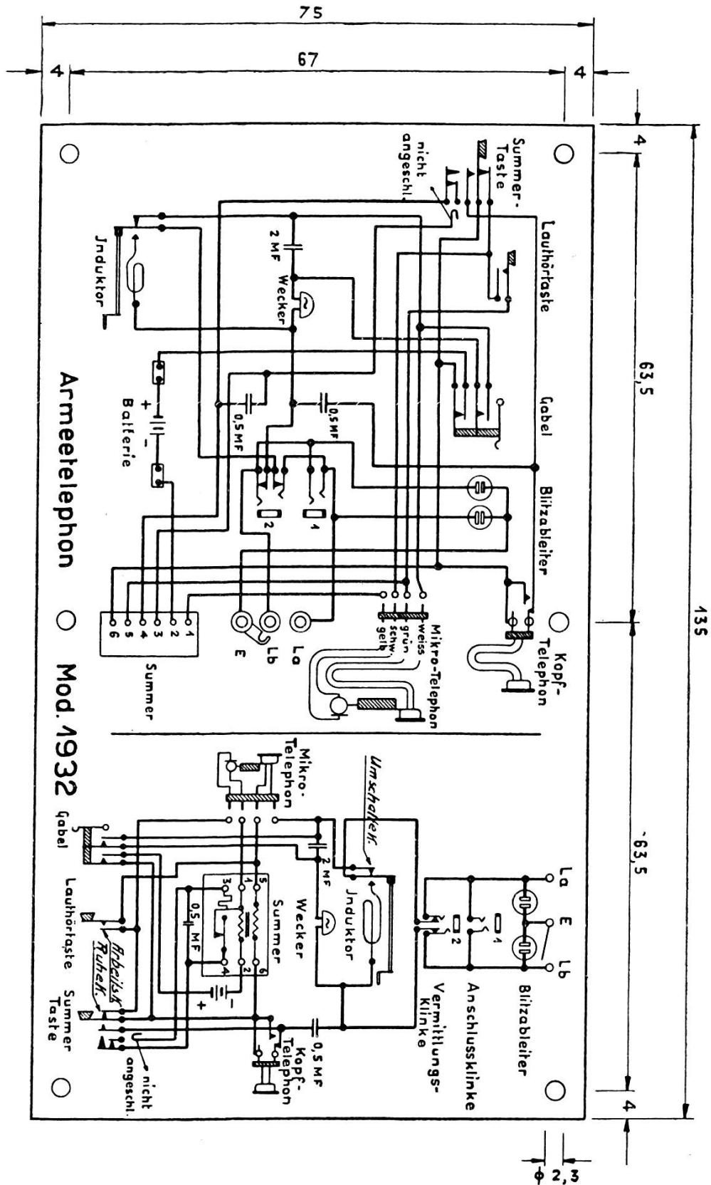
*Aufruf der Zentrale mit Induktor:* Induktor, RK VKli, Lb, zur Zentrale, zurück auf La, RK VKli, umgelegten UK des Induktors zum Induktor.
