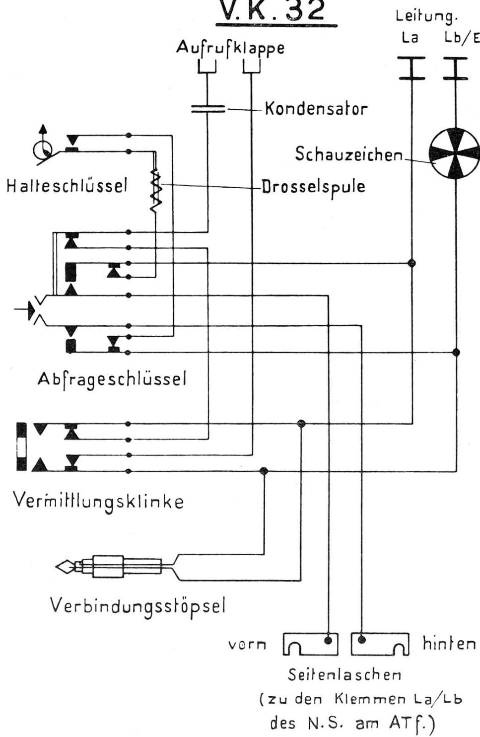
Der Halteschlüssel ist so konstruiert, dass er in der Stellung «aus» den Abfrageschlüssel verriegelt. Dieser kann daher nur in
