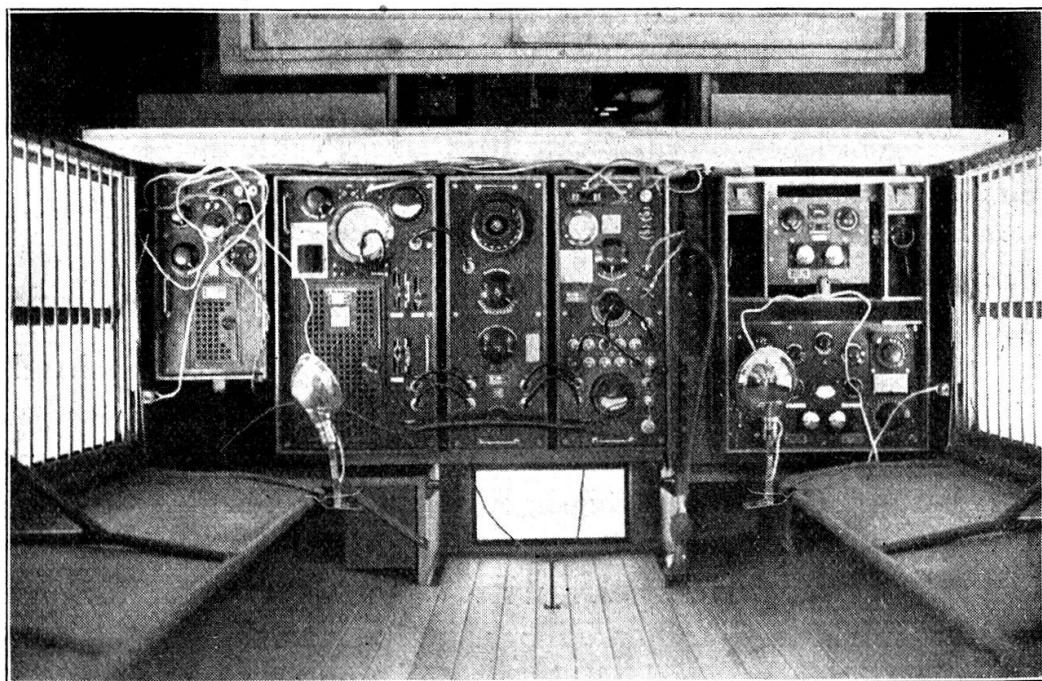
Der gewiegte Funker erkennt in den hinter dem Führersitz angeordneten Apparaten sofort den 200 Watt-Sender und den Normalempfänger der fahrbar schweren Station. Darunter sind die Zusatzapparate für Heiz- und Anodenstrom der Gleichrichter-
