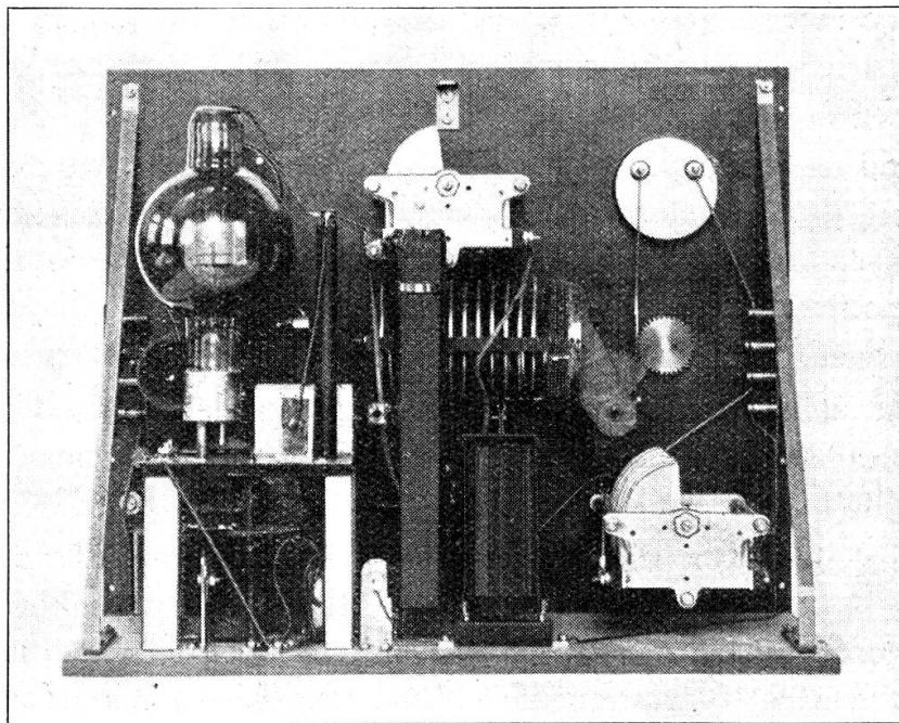
*Zwischenkreis- und Antennen-Drehkondensator* besitzen eine Maximalkapazität von je 330 cm. Der Plattenabstand muss entsprechend der Leistung des Senders ziemlich gross gewählt werden und beträgt bei den hier eingebauten Kondensatoren 2,1 mm Luftdistanz.
