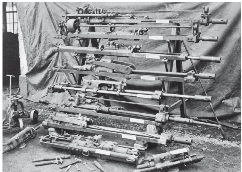
Différentes foreuses utilisées au Gothard. Du haut vers le bas: Sommeiller, Ferroux, Ferroux améliorée Turrettini, Mac Kean, Dubois, Seguin et Burleigh.
