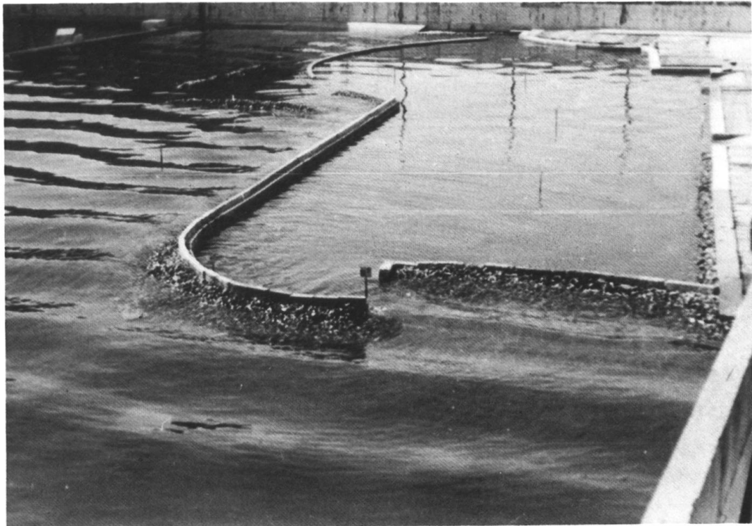
Station d'essais maritimes. Modèle du Port d'Angra-Les Açores
