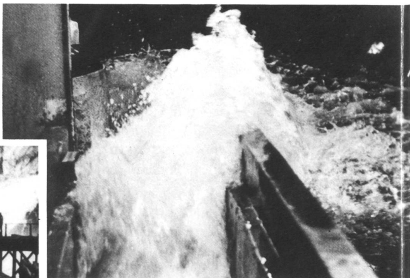
Barrage de Génissiat. Modèle de l'évacuateur de crue sur la rive gauche
