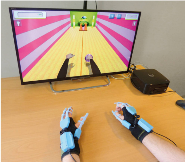
YouGrabber VR-Rehabilitationssystem für obere Extremitäten zeigt das Training von gegenseitigen Bewegungen zum Erreichen und Greifen. | Le système de rééducation de RV YouGrabber pour les extrémités supérieures montre l'entraînement de mouvements réciproques pour atteindre et attraper des objets.
