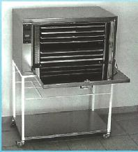
Edelstahl, allseitig isoliert, für max. 18 Wärmeträger 30x40 cm. Umluftgebläse und Ringheizkörper sorgen für gleichmässige Temperaturverteilung. Ein Mikroprozessor mit Digitalanzeige steuert die Ein- und Ausschaltzeiten und regelt die Temperatur genaustens. Untergestell mit Lenkrollen und Zwischentablar.
