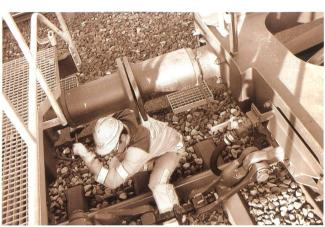
Etwa 400 Mal pro Nachtschicht muss sich der Rangierer beim Fertigmacher der Züge unter die Puffer beugen.
