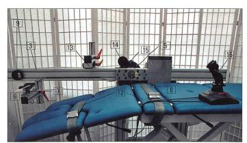
Abb. 2: Die SLR-Maschine und ihre elektromechanischen Funktionsteile (Vorderansicht).
