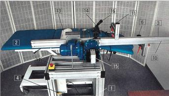
Abb. 3: Die SLR-Maschine und ihre elektromechanischen Funktionsteile (Rückansicht).
