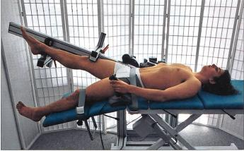
Abb. 4: Der über die Laserpointer ausgerichte und mit Gurten fixierte Pro- Abb. 5: Die SLR-Maschine in der Bewegung. Der Proband steuert die Aufwärtsbewegung, den Bewegungsstop und die Abwärtsbewegung mit dem Joystick selbstständig. Der Proband bestimmt damit über das maximale mögliche Bewegungsausmass.
