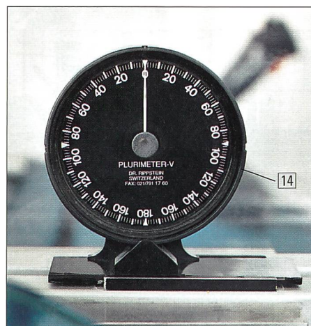
Abb. 13: Ein Plurimeter-V (= vertikal) [14] nach Dr. Rippstein (Gerhardt u. Rippstein 1992, 66ff) ist auf dem SLR-Beinausleger befestigt und informiert unmittelbar über den Hüftflexionswinkel.
