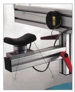
Abb. 8: Unter der Unterschenkelplatte [6] befindet sich der querkraftstabilisierte Kraftmesser [7]. Der Laser [9] wird auf den prominentesten Punkt des Malleolus lateralis eingestellt.
