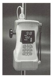
Pulsoxymeter mit Schlafmodus-Software. Akkukapazität: 12 Stunden. Auch für den Notfall, in der Anästhesie und Reanimation geeignet, da mit akustischem und visuellem Alarm versehen.
