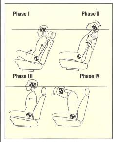
Abb. 1: Phasen einer Heckkollision
