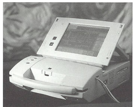
Abb. 8: Das Programmiergerät ist ein tragbarer PC mit Touch-Screen anstelle einer Tastatur. Das Kabel auf der rechten Seite des Geräts geht zum (nicht abgebildeten) Programmierkopf.
