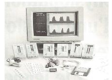
Eigenschaften der Geräte: Arbeit/Ruhe oder Dauermodus, automatische Datenspeicherung bis zu 32 Trainingseinheiten, Funktionsstimulationsmodus, Adapter zum Anschluß an eine Vielzahl Beckenbodensensoren, Zielvorgaben, erfolgsorientierte auditive und visuelle Verstärkung, serielle Schnittstelle mit Kabel für PC Anschluß, tragbar – leichter als 0,28 kg. Möglichkeit der Datenübertragung
