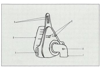
Schéma 4: Masque nasal standard: A: fixation du harnais – B: joint siliconé – C: connexions 02 (si besoin) – D: orifice calibré de fuite expiratoire – E: connecteur au circuit.
