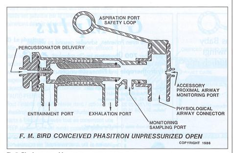
Fig. 5: Phasitron en position ouverte.
