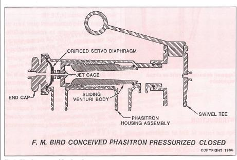
Fig. 3: Phasitron en position fermée.
