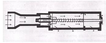
Fig. 2: Un débitmètre de pointe: Le «Mini-wright-peak-flow-meter».
