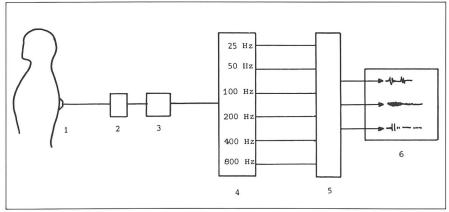
Fig. 2 Schéma du phonopneumographe:
