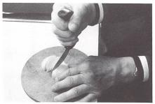
Abb. 15: «Rfsu»-Messer mit Spezialgriff – das Handgelenk bleibt in einer guten Stellung, der Druck auf die Fingergelenke fällt weg.
