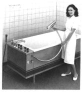
Medizinalbad-Kombination: häuse 2 mm Anticorodal für hohe Stabili-tät • Wanne Stahlblech, säurebeständig, weiss emailliert oder Chromnickelstahl weiss emailliert oder Chromnickeistah 18-8-2 • Gehäusefarbe nach Ihrei Wahl • eingebaute Kohlensäure-Imprägnierarmatur • auf Wunsch, ein-gebaute Sole-Dosiervorrichtung mit elektronischer Wähltastatur • komkompakte Abmessungen: 200 x 80 cm
