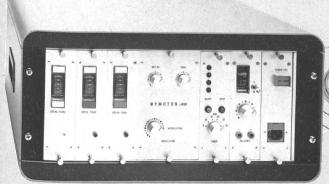
WYMOTON Klinikgerät für die kombinierte MF+NF Wechselstrom-Therapie - ermöglicht alle klassischen Indikationen der Gleichstromtherapie und der Reizstromtherapie mit nieder- und mittelfrequenten Strömen. Mittelfrequenz (11 kHz) und Niederfrequenz (250 Hz) in einem Gerät, für die individuelle Therapie, entwickelt von Physiologen für Physiotherapeuten!
