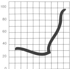
Optimale Sitzprofile für Arbeit und Ruhe: Aufgrund der bisher gewonnenen Erkenntnisse wurde das Sitzprofil eines Mehrzweck-Arbeitssitzes und das Sitzprofil eines Ruhesessels entwickelt, die beide in verschiedenen Tests ein Minimum an subjektiven Beschwerden ausgelöst haben. Das Ergebnis, auf eine einfache Formel gebracht: Ein gutes Sitzprofil ist besser als ein dickes Polster...
