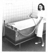
Medizinalbad-Kombination: Medizinalbad-Kombination: • Gehäuse 2 mm Anticorodal für hohe Stabilität • Wanne Stahlblech, säurebeständig, weiss emailliert oder Chromnickelstahl Weiss erhälliert oder Chrominckeistali 18-8-2 • Gehäusefarbe nach Ihrer Wahl • eingebaute Kohlensäure-Imprägnierarmatur • auf Wunsch, ein-Sole-Dosiervorrichtung elektronischer Wähltastatur pakte Abmessungen: 200 x 80 cm
