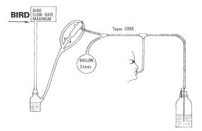
Schéma de montage du CPAP
