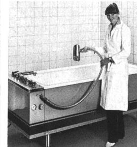
**Medizinalbad-Kombination:** ● Gehäuse 2 mm Anticorodal für hohe Stabilität ● Wanne Stahlblech, saurebeständig, weiss emailliert oder Chromnickelstahl 18-8-2 ● Gehäusefarbe nach Ihrer Wahl ● eingebettete Kohlensäure-Imprägnieranlage ● auf Wunsch, eingebaute Sole-Dosierzvorrichtung mit elektronischer Wählstatratur ● kompakte Abmessungen: 200 x 80 cm
