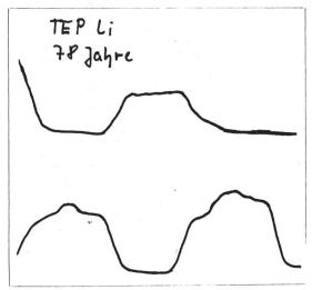
Abb. 5: Drei-Punkte-Gang — geringe Entlastung des linken Beines
