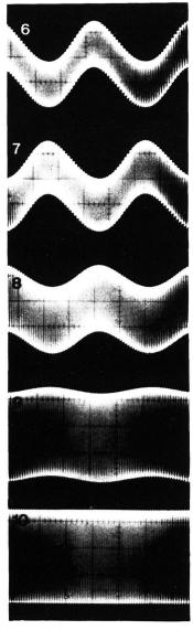
Abb. 1 Gegensinnige Amplitudenmodulation der beiden durch Addition einander überlagerten Wechselströme derselben Maximalamplitude:
