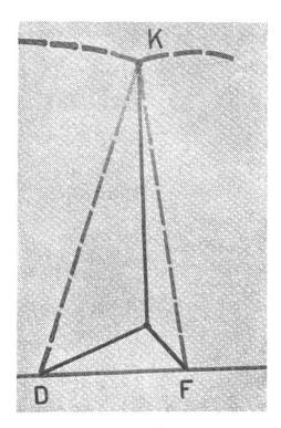
Abb. 2 Bei jeder Lageänderung muss der Winkelhebel (Fuss) über D und F gekippt werden.
