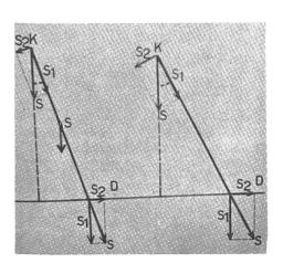
Abb. 4 Darstellung der Kräfte bei einem schräg stehenden Stab
