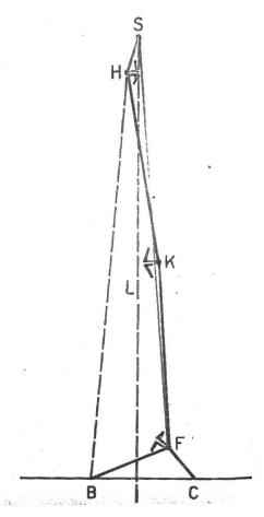
Abb. 6 Ausnutzung der Schwerkraft zur Sicherung der Gelenke (Sperrungen)
