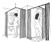
Anstelle fester Zwischenwände treten heute mobile Vorhangabtrennungen, denn sie sind anpassungsfähig und lassen volle Bewegungsfreiheit bei Arbeit und Reinigung.
