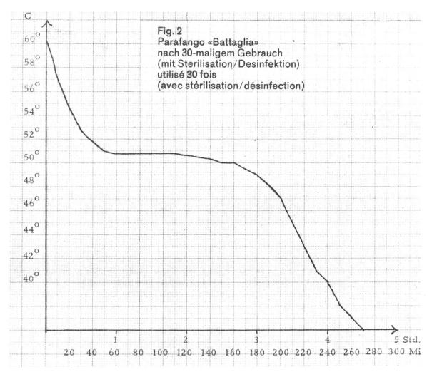
Les mesures ont été effectuées au milieu d'un cylindre de matière ayant environ 11 cm de hauteur et 8 cm de diamètre.
