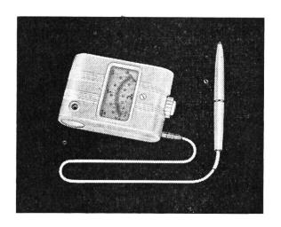
Das innert Sekundenfrist anzeigende Thermometer für Messung von Fieber, Haut- und Differenztemparaturen.
