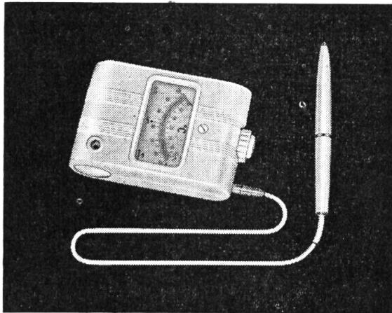
Das innert Sekundenfrist anzeigende Thermometer für Messung von Fieber, Haut- und Differenztemperaturen.
