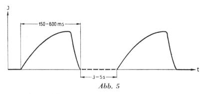
Impulsfolge mit langen Dreieck-Impulsen und ausgedehnten Pausen, zur Behandlung von Lähmungen mittleren bis schweren Grades.
