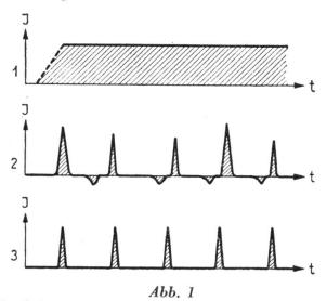
1. Galvanischer Strom, konstanter Gleichstrom, 2. Faradischer Strom, ursprüngliche Form, von einem Induktorium erzeugt, völlig unregelmässig, Stromtärke nicht messbar. 3. Dreieck-Impulsfolge, entsprechend dem faradischen Strom, exakt definiert und messbar.
