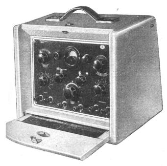
Sanostat-Apparat für galv. und farad. Ströme (konstant mit Impulsen und Schwellstrom)
