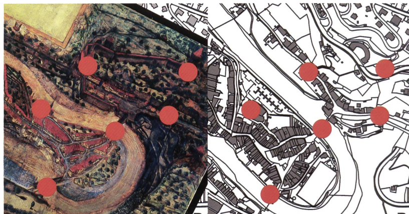
Fig. 22 Jalons de triangulation des quartiers de l'Auge et des Forgerons (Vue de Grégoire Sickinger et cadastre actuel). – On constate que leur position correspond exactement à la réalité topographique. La géométrie des jardins à l'arrière de la rue Zaehringen, difficile à saisir in situ, est ainsi correcte. L'exagération de la distance entre la porte de Berne et la tour Rouge découle de la position du dessinateur situé en-dessous des ouvrages.
