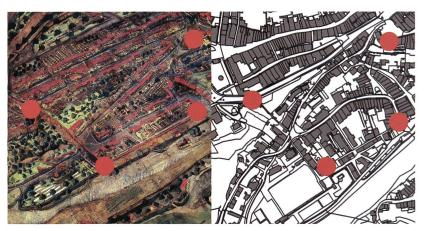
Fig. 23 Jalons de triangulation des quartiers de la Grand-Fontaine et de la Neuveville (Vue de Grégoire Sickinger et cadastre actuel). – L'Hôtel de Ville et les trois angles de l'enceinte de la Neuveville forment un trapèze presque isocèle. Les légères déformations du dessin par rapport au plan cadastral sont à nouveau perceptibles sur le haut.
