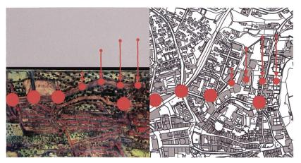
Fig. 25 Jalons de triangulation du nord de la ville (Vue de Grégoire Sickinger et cadastre actuel). – On constate ici que Sickinger a modifié, en l'abaissant, le tracé de la 3º enceinte occidentale, du Belluard à la tour-porte de Morat, afin de faire entrer cette portion de la ville dans son cadre. La répartition des ouvrages sur l'abscisse reste précise.
