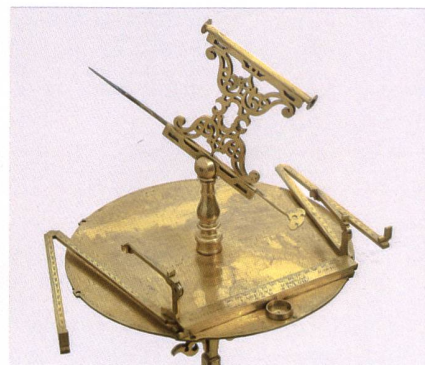
Fig. 35 Le perspectographe curviligne de l'ingénieur militaire Baldassare Lanci (1510-1571), 1557, laiton doré, Ø 30 cm, H avec support 139 cm (Florence, Museo Galileo, inv. 152, 3165). – Sur cette variante du perspectographe, qui est aussi l'un des plus anciens conservés, on fixait la feuille au bord du plateau, en demi-cercle. En 1583 déjà, dans ses « Deux règles de la perspective pratique de Vignole », le mathématicien et cosmographe dominicain Egnatio Danti démontra l'inexactitude des perspectives dessinées avec ce type d'instrument.
