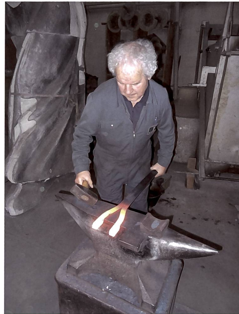
Abb. 132 Neue Beschläge werden in der Glockengiesserei H. Rüetschi AG in Aarau handgeschmiedet.
