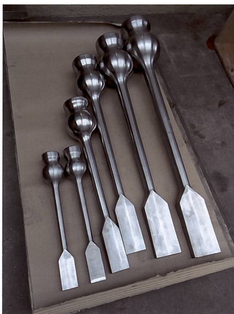
Abb. 133 Die neuen Klöppel sind auf schonendes Anschlagen ausgelegt.
