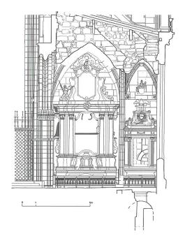
Abb. 64 Südliches Seitenschiff, Ostwand. Aufnahme während der Restaurierung 2010. Hinter dem Sakramentsaltar links Stifterfigur des Ritters Hans von Lanthen Heidt, 1579, zum Vorgänger-Altar; in der Mitte, hinter dem Hauptbild, Jahreszahl 1753. Im Dachraum Befund der ursprünglich geplanten geringeren Breite des Seitenschiffs, der ausgeführten Breite sowie des Anschlusses der Seitenkapelle mit ebenerdigem Durchgang zur Sakristei. Familiengruft der Falck, später der Praroman.
