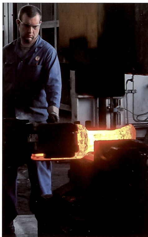
Fig. 14 Fabrication du nouveau battant de la cloche de Sion à la forge Imbach & Cie à Nebikon (LU).
