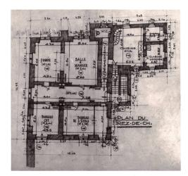
Fig. 89 Relevé de la commanderie en novembre 1925 en vue de de sa transformation en pavillon des officiers, plan du rez-de-chaussée (AEF, Fonds du Service des bâtiments).
