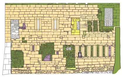
Fig. 26 Relevé pierre à pierre et phases de construction du mur goutterot ouest de la dépendance.
