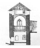
Fig. 28 Chapelle Saint-Jean-Baptiste, d'après les relevés du Département des bâtiments, 1941. Le niveau défensif inférieur de la tour n'était accessible que par une trappe aménagée dans le sol de la chapelle. Abb. 28 Johanneskapelle, Aufnahme des kantonalen Hochbauamts, 1941. Zum Schiessposten im Untergeschoss führte eine Falltür im Kapellenboden.
