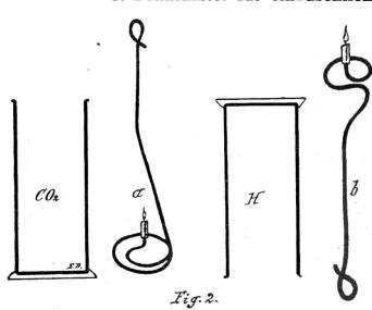
Jeder Lehrer, der schon im Falle war, chemische Versuche auszuführen, hat wohl die Erfahrung ge-macht, dass beim Eintauchen kleiner Kerzenflammen in Gase, welche in Zylindern bereit stehen, durch abtropfendes Wachs die Glaswand beschmutzt wird, und er weiss auch, dass die Reinigung des Zylinders mitunter recht zeitraubende Arbeit ist. Meist rührt diese Unannehmlichkeit von einer zu grossen Annäherung der
