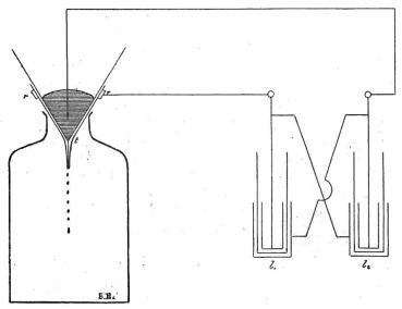
Auf die Tatsache, dass Quecksilber durch Reiben an Glas stark elektrisch wird, sich stützend, hat H. Wiesent, München, eine einfache Vorrichtung zusammengestellt, die er als Elektrisiermaschine empfiehlt. Ein
