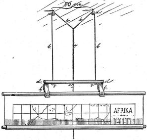
1. Die 2 Greifer (f Fig. A) öffnen und schliessen sich, einem leichten Druck der Hand folgend (Fig. B), selbsttätig und sind so exakt gearbeitet, dass sie nicht nur Stäbe bis
