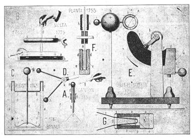
Meinhold, Physikalische Wandbilder. Tafel 12: A. Das Blättchenelektroskop. B. Der Elektrophor. C. Die Leidnerflasche. D. Der Auslader. E. Die Electrisirmaschine. F. Durchschnitt der Elektrisirmaschine. G. Der elektr. Zünder.
