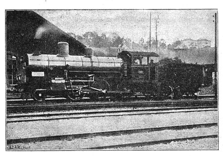
Photographie A. Blanc, à Lausanne. La nouvelle locomotive des Chemins de fer fédéraux, avec vapeur surchauffée.
