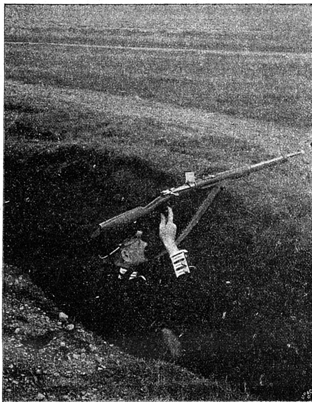
Miroir réflecteur adapté au fusil et montrant le but au tireur
