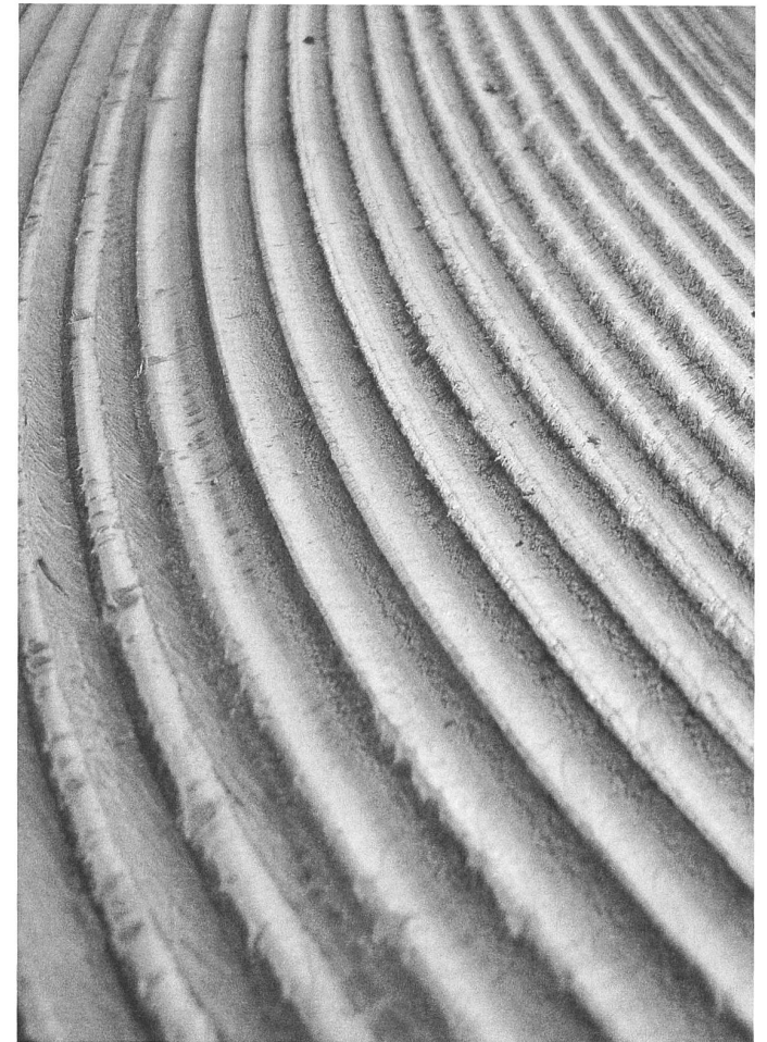
CNC-gefrästes Modell, Detail.
