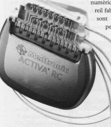
▲ Haute technologie en taille réelle : le stimulateur neurologique rechargeable Medtronic Activa RC mesure 54 mm de haut, 54 mm de large, 9 mm d'épaisseur et pèse 40 grammes.
